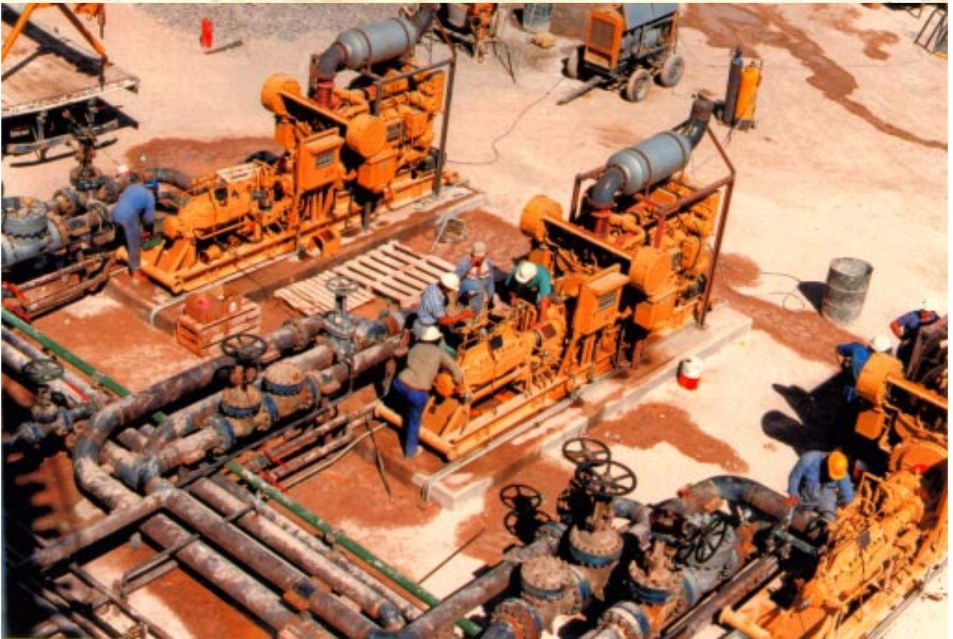
Instalación de tres motores de inyección de agua a pozos petrolíferos
